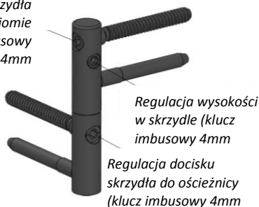
Rys. 7. Regulacja zawias typ C.
